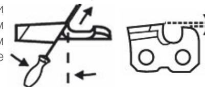
Вставьте напильник в режущий зуб цепи. Сделайте 3-4 движения на вылет под углом к шине 30°. По мере стачивания режущего зуба, необходимо подтачивать и ограничитель реза плоским напильником
